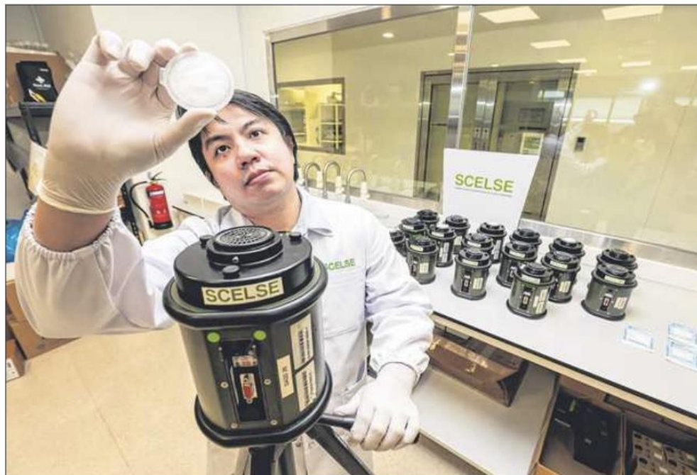
何从繁博士展示的是空气监测设备。该设备对环境中病毒的检测率要远高于一般表面拭子采集样本的检测率。 (陈斌勤摄)
